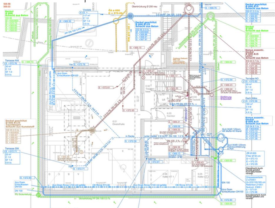
Muster-Kanalisationsplan für ein Trennsystem mit allen benötigten Angaben
